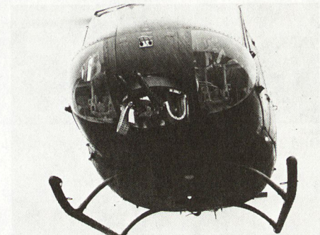
Bild 19. Bell UH-1D mit Zwillings-Maschinengewehr
