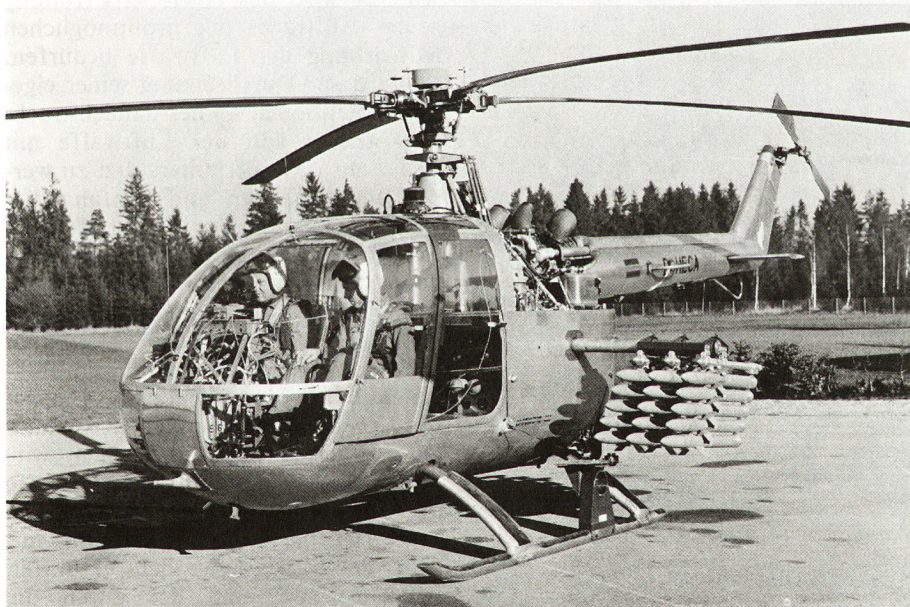
Bild 16. Bo-105 mit un gelenkten Raketen
