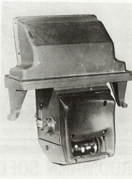
**Bild 6.** Passives Fahrerperiskop.
