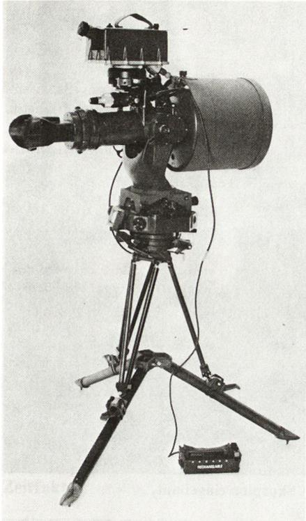
**Bild 2.** Nachtbeobachtungsgerät Kat. A mit Simrad LP6-Laserdistanzmesser aufmontiert.
