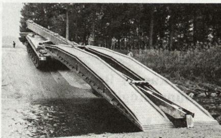
Bild 4. Ausfahren der Brücke mittels Schiebewagen
