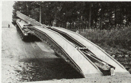
Bild 4. Ausfahren der Brücke mittels Schiebewagen
