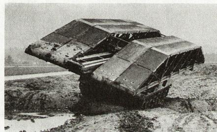
Bild 2. Brückenpanzer 61 mit MAN-Genieschiebebrücke
