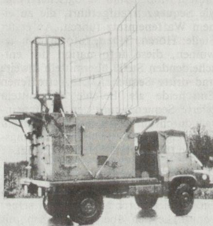
Bild 3. Ein hochwirksamer Störsender mit betriebsbereiter Antennenanlage.
