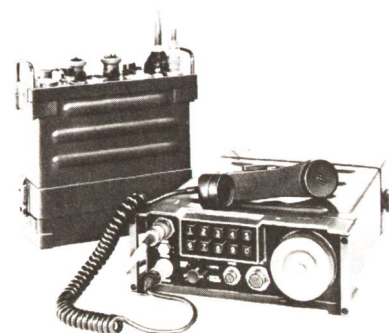
Bild 2. Gretacoder 202. Portable High Security Speech Cipher Unit. Tragbares Sprachchiffriergerät höchster Sicherheitsstufe. ■
