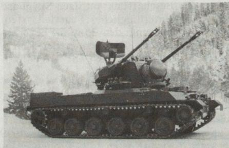
zers 68 aufgebaut. Die Bewaffnung besteht aus **zwei 35-mm-Kanonen** und einem **integrierten, radargesteuerten Feuerleit-system**.
