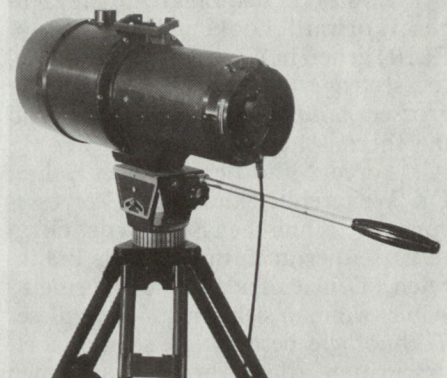
Bild 2: Restlichtverstärker-Kamera (LLL-TV-Kamera) von Siemens-Albis.
