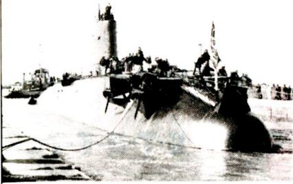
Tiefgang beträgt 8,2 m, die Verdrängung rund 4200 t und die Unterwassergeschwindigkeit 30 Knoten. Die Besatzung beläuft sich auf 97 Mann. jst
