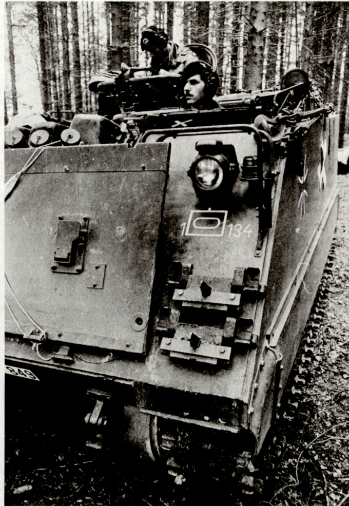
Bild 6. Panzerabwehrhubschrauber (PAH-1) unterstützen die Bodentruppen. Bild 7. Der Kampfpanzer Leopard steht derzeit im Vordergrund. Bild 8. Gepanzerter MTW M-113, Standardfahrzeug der ungepanzerten Infanterie.
