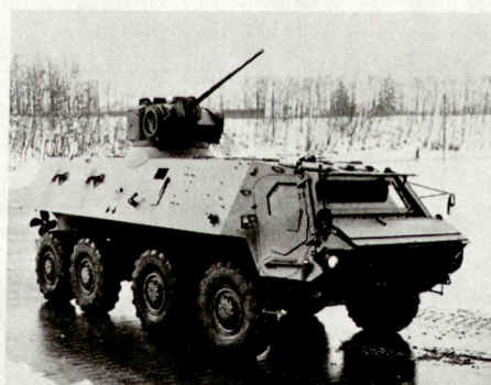
TPz (8x8) in der Variante Infanterie-Gefechtsfahrzeug mit 1-Mann-Turm, 25-mm-Kanone und 13 Mann Besatzung.
