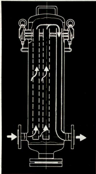
FILTERWERKSTOFF AUS POLYPROPYLENFILZ (DIVERSE FEINHEITEN, BESTÄNDIG BIS 100° C FUER VIELE SAEUREN, LAUGEN UND LOESUNGSMITTEL) ODER AUS EDELSTAHLDRAGTGEWEBE. VERLANGEN SIE UNSERE BERECHNUNGSUNTERLAGEN
