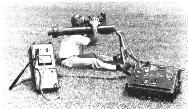
Bild 3. Abschusswirkungs-Simulator mit Behälter für die Gasflaschen (links) und Überwachungsgerät (rechts).
