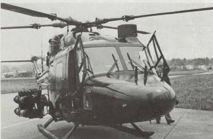
**Bild 3.** Multirole-Helikopter haben im Rahmen der verfügbaren Gesamtzuladung Kampffähigkeit und/oder Transportkapazität. Sie sind relativ rasch und vielfältig umrüstbar. Auf dem Bild ein Westland AH 1 Army-Lynx mit der PAL TOW (GB).
