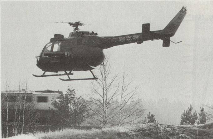
**Bild 1.** Einfachen Panzerabwehrhelikoptern, die ursprünglich als Verbindungs- und Beobachtungshelikopter konzipiert wurden, ist ein Luft-Boden-Panzerabwehrenkennungssystem permanent integriert worden. Er verschiebt sich im Schleichflug und kämpft aus halbgedeckten Stellungen im feindfreien Gelände. Auf dem Bild eine MBB Bo-105 mit der PAL HOT (BRD).
