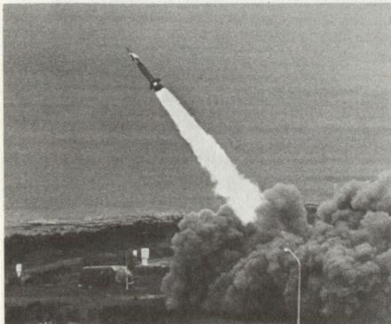
Das Bild zeigt die Startkonfiguration, Tandembooster (Artillerieraketenmotor Honest John) und EFA-Flugkörper kurz nach dem Verlassen der Startlafette. jst
