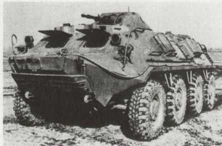
Beim geschlossenen SPW kann aus speziellen Schiessluken MPi-Feuer abgegeben werden.
