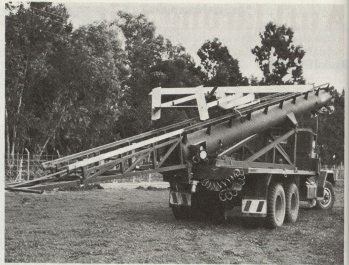
Bild 3. Werferfahrzeug mit Startschiene und der Druckluftflasche.
