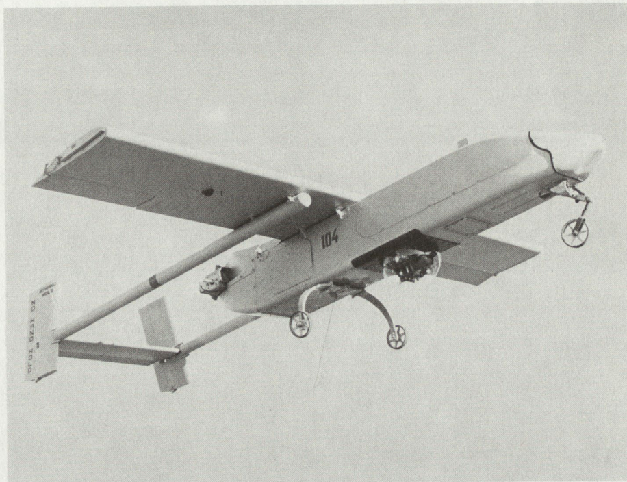
Bild 1. Das von der «Israel Aircraft Industries» entwickelte «Scout»-Kleinflugzeug mit schwenkbarer Mini-Fernsehkamera und Fotogerät für Panoramaaufnahmen. Das Fahrgestell ist bei neueren Modellen durch Kufen ersetzt worden.
