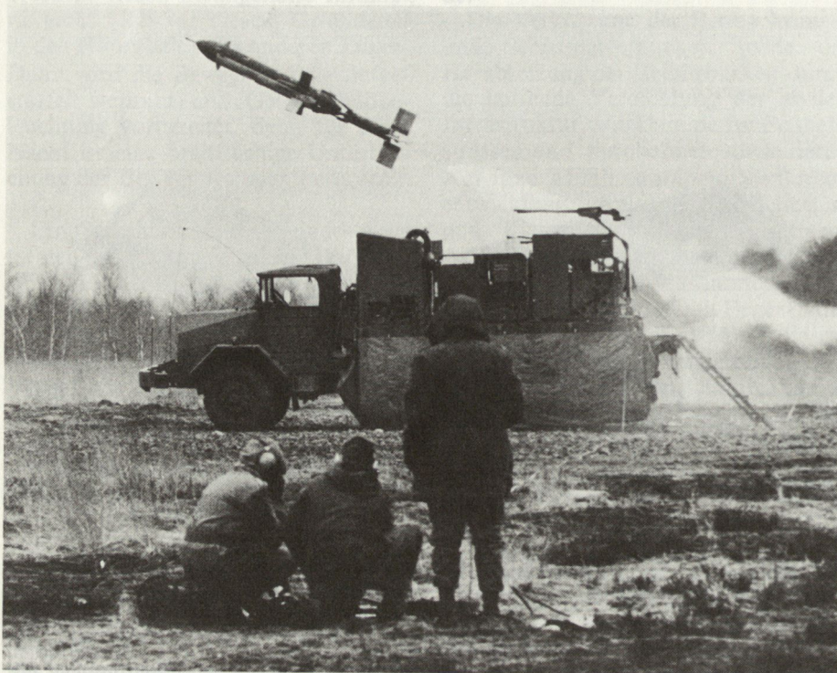
Bild 4. Mit einem Feststoff-Strahltriebwerk wird die Drohne vom Werferfahrzeug auf die vorbestimmte Flugbahn abgeschossen.
