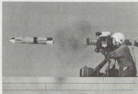
BILL zeichnet sich in mehreren Punkten aus. Sie fliegt über der Ziellinie, und die Hohlladung wird durch Annäherungsfunktion ausgelöst. Somit überfliegt die Waffe auch Hindernisse im Gelände und greift Kampfpanzer von oben an. Dadurch werden die schwächer gepanzerten Teile des Panzers getroffen, und die Sprengladung hat einen kürzeren Durchschlagsweg. jst
