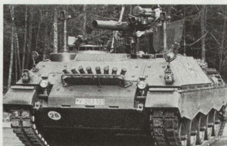
Kampf gegen die vorhandene Überzahl an Panzern des Warschauer Pakts. Der Jaguar 2 ist mit dem Panzerabwehrraketensystem TOW ausgestattet, mit dem angreifende Panzer auf eine Entfernung bis 3000 m bekämpft werden können. Der Jagdpanzer ist durch ein Nachtziel- und Beobachtungsgerät nachtkampffähig.
