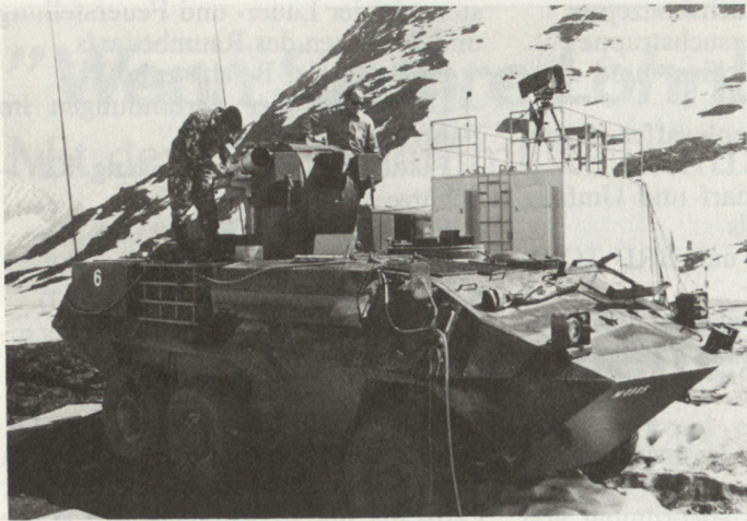
Bild 2. Justierung der Zielgeräte TV-Kamera mit eingblendetem Fadenkreuz. Im Hintergrund Versuchseinsatzwagen I mit einer Schwarz-/Weiss-TV-Kamera, diese dient zur Aufnahme der Lenkwaffenflughahn.
