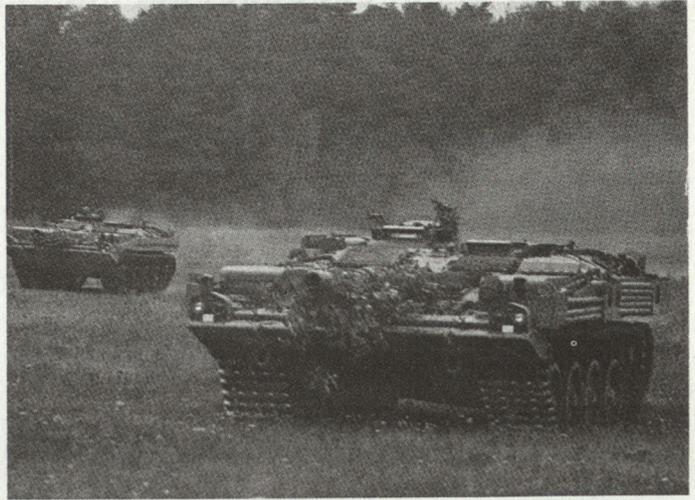
**Bild 5.** Die Panzerbrigaden des Heeres sind mit dem in Schweden hergestellten Panzer S mit einer vollautomatischen 105 mm in Chassis fest montierten Kanone ausgerüstet. Er hat ein niedrigeres Profil als alle anderen vergleichbaren Panzer.
