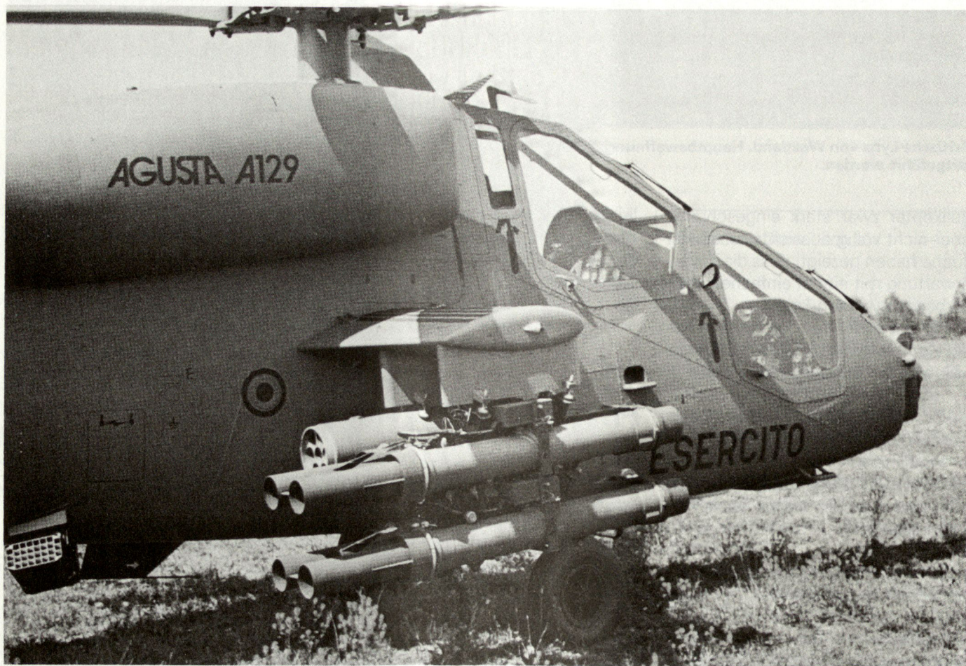
Die italienische Agusta A 129 Mongoose von Agusta-Milano. Bewaffnung: 8 TOFW Lenkwaffen, dazu alternativ Raketen und / oder Mg verschiedener Kaliber.
