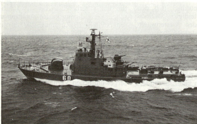
Schnellboot-Klasse Helsinki, in Finnland gebaut, mit schwedischen Seekampf-Flugkörpern ausgerüstet.
