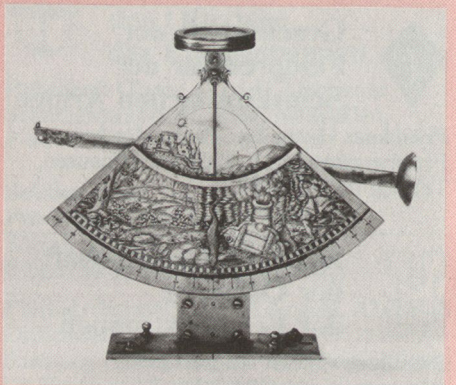
Pendelrichtquadrant mit Bussole (um 1650).
