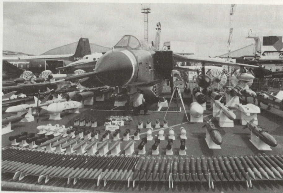
Bild 1. Waffendisplay der Tornado Interdiction-/Strikeversion der Bundeswehr. Unter dem Rumpf sieht man die Hauptbewaffnung, den MW-1 Behälter mit Submunition.
