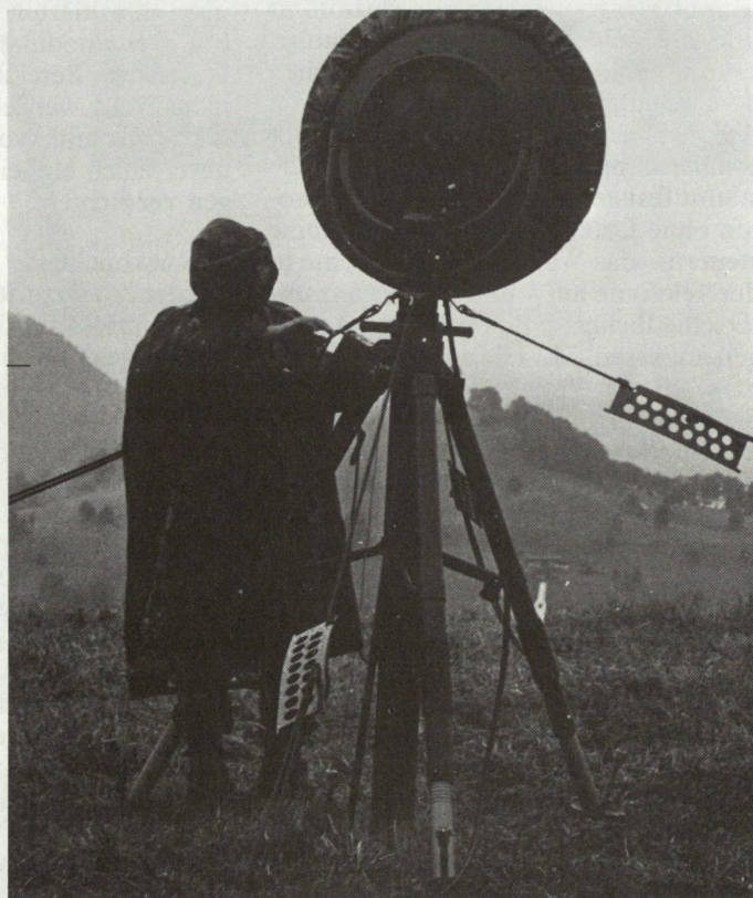
Bild 4. Parabolspiegel der gegenwärtig in Truppenversuchen stehenden Richtstrahlstation R-915. Mit dieser Ausrüstung lassen sich 60 Kanäle im Mikrowellenbereich gleichzeitig übertragen. Hersteller Standard Telefon und Radio AG, Zürich.
