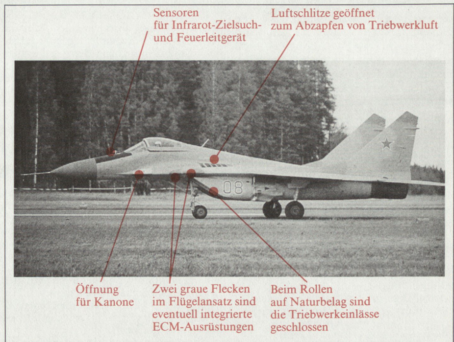
Bild 1. MiG-29 «Fulcrum» im Rollzustand. Die Triebwerkeinlässe sind geschlossen, die erforderliche Luftzufuhr erfolgt durch Schlitze an der Rumpfoberseite.
