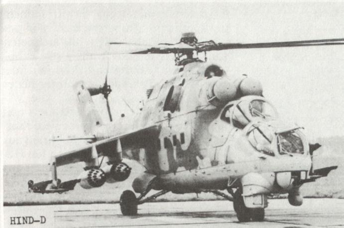
Der Mi-24 HIND-D verfügt über folgende Waffen: Eine schwenkbare, 4-läufige 12,7-mm-Gatling-Kanone im Kinn-turm, max. 4 Behälter UB-32-57 mit je 32 Abschussrohren für total 128 ungelenkte Raketen vom Typ S-5, verschiedene Spreng-/Splitterbomben und Submunitionsbomben, C-Kampfstoff-Behälter, Luftverminungsbehälter, je 4 Panzerabwehrrenk Waffen AT-2 Swatter-B.
