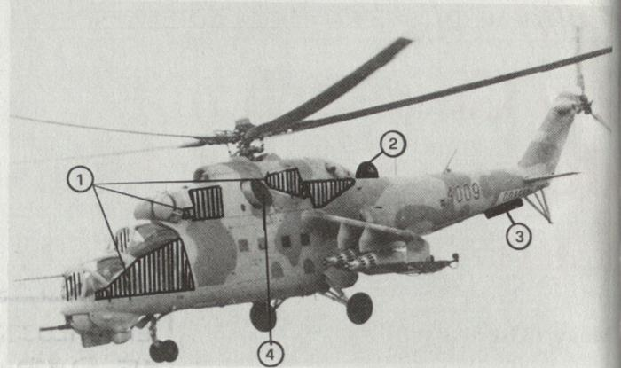
Der Mi-24 HIND-D ist teilweise gepanzert (1), verfügt zum Selbstschutz über ein IR-Stroboskop, d. h. eine IR-Strahlungsquelle (2), Düffel- und Fackel-Ausstossergerät (3), eine Ummantelung der Abgasrohre zur Unterdrückung der Triebwerk IR-Abstrahlung (vgl. das Foto des nach Pakistan geflogenen Mi-24) (4) und ein Radarwarngerät.
