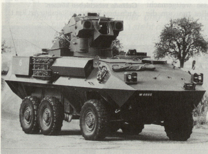
Bild 1. Panzerjäger. Fahrzeug PIRANHA 6×6, Lenkwaffe TOW-2
