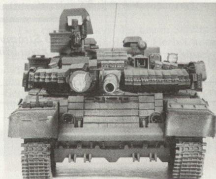
Die beiden Bilder zeigen ein mit Reaktivpanzerung ausgestattetes Modell des neuesten sowjetischen Panzers T-80. Die Anbringung der Reaktivpanzerung soll «naturgetreu» wiedergegeben sein.
