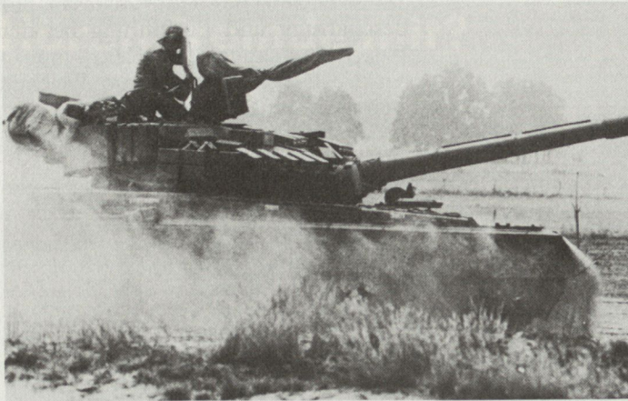
Bild 2a. T-80 mit Reaktivpanzerung (Soviet Military Power 1987).
