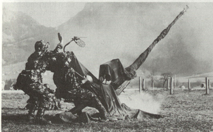
Die Flab-Kanone 54 mit ihrem 20-mm-Geschütz ist in mehreren hundert Exemplaren in unserer Armee zu finden. Sie kann auch gegen Helikopter bis auf eine Schussdistanz von 2000 m eingesetzt werden.
