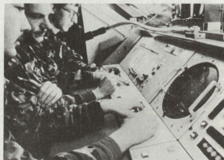
Das Kommandopult des Feuerleitgerätes SKYGUARD . Hier wird der Einsatz der 35-mm-Flab gesteuert.
