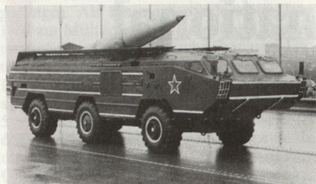
Taktisches Lenkwaffensystem SS-21 SCA-RAB auf dreiaxigem Radfahrzeug ZIL-5937. Zu jedem Abschussfahrzeug gehören ein bis zwei Nachladefahrzeuge mit je 2 Lenkwaffen.
