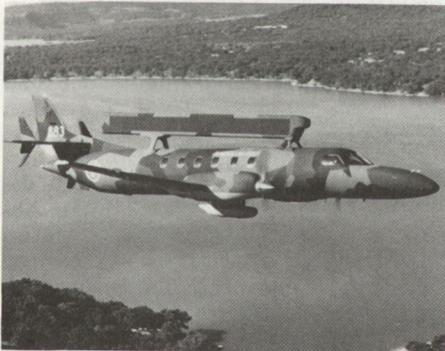
Mit dem System ASGC werden Radarsignale an Bord gerechnet und mittels Data link an bodengestützte Controller übermittelt. Die Einsatzdauer in dieser Konfiguration mit dem Trägerflugzeug Fairchild Metro III (siehe Bild), liegt zwischen 4 bis 6 Stunden mit einer Reichweite von ungefähr 185 km. Das System ASAC ermöglicht autonome Einsätze. Das Trägerflugzeug Saab SF 340 ist für 4 Operateure ausgerüstet und ermöglicht eine Einsatzdauer von 7 bis 9 Stunden über eine Reichweite von ungefähr 185 km.
