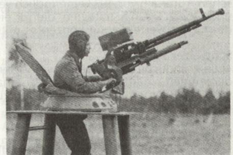
**Richtübungsgerät Fliegerabwehr-Mg der NVA.**
