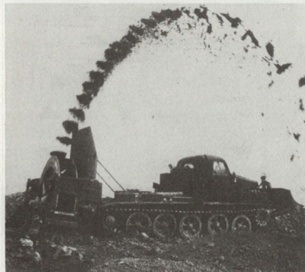
Grubenbagger MDK-2 M auf Kettenfahrgestell AT-T. Dieser Bagger wird gegenwärtig durch MDK-3 abgelöst (Anmerkung Red.).
