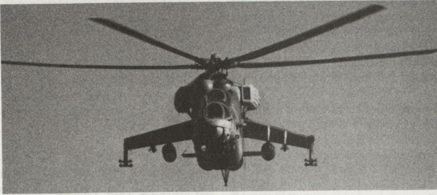
**Sowjetischer Kampfhelikopter Mi-24 HIND. Deutlich sichtbar sind die seitlich montierten Abgaskühler, die dem Schutz vor Stinger-Abschüssen dienen sollen.**
