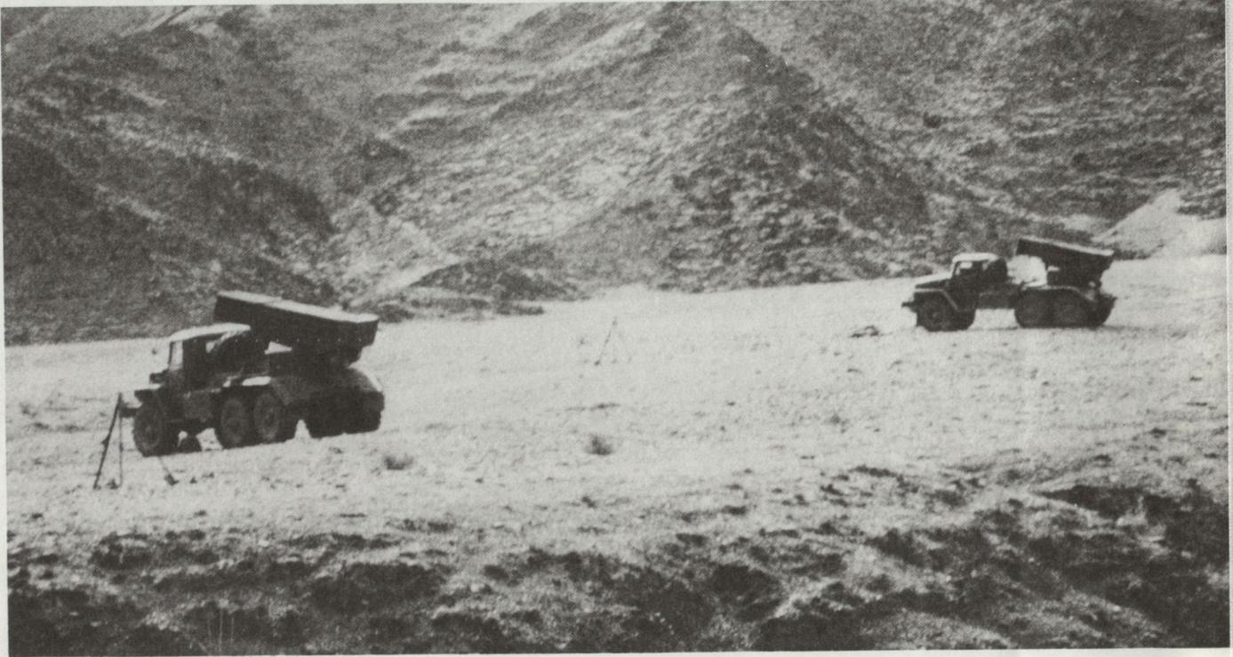
Sowjetische Mehrfachraketenwerfer vom Typ BM-21 in Feuerstellung bei der Grenzstation Torkham. Foto: Beat Krättli
