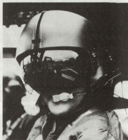
Abb. 8. Für Flugführung und Waffeneinsatz stehen der Besatzung moderner Kampfhubschrauber Helmvisier- und -blickfeldarstellungsgaräte zur Verfügung. Mit dem auf unserem Foto gezeigten IHADSS-System, von Honeywell für den Einsatz mit dem Kampfhubschrauber AH-64A Apache entwickelt, lassen sich auch alle mitgeführten Waffen einsetzen, wobei folgende Höchstschussweiten erreicht werden: Geschützbewaffnung: 2000 m, Ungelenkte Raketen: 1500 m; Drahtgesteuerte Panzerabwehrlenk Waffen; 4000 m; Lenkflugkörper mit Laser- oder Infrarot-Wärmebild-Zielsuchkopf: 6000–8000 m und Luftzielraketen als Bestandteil der Selbstschutzbewaffnung: 4000 m.
