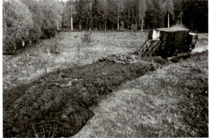
**Geländelastwagen beim Ausbringen von Tarnschaum zur Abdeckung von Fahrspuren.**
