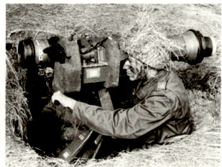
Panzerabwehrlenkwarensystem «Bill» des schwedischen Herstellers Bofors.
