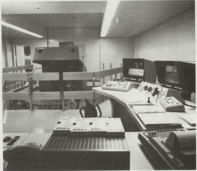
Abb. 5: Fahr Simulator «FASIP Leo», Fahrerkabine und Ausbilderpult
