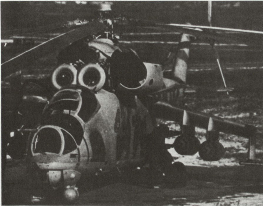
Bild 2. Mi-24 Hind C, an den Flügelkonsolen vier Behälter für 57-mm-Raketen, in der Rumpfnase das voll schwenkbare Gateling-Maschinengewehr.
