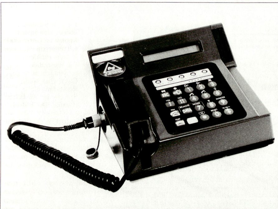
Standard-Endgerät im Integrierten Militärischen Fernmeldesystem (IMFS) wird das digitale Telefon mit integraler Verschlüsselung und Datenanschluss sein. (Bild: BAUEMSid)
