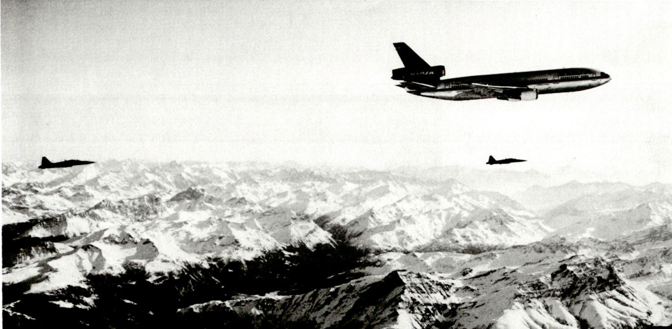
Ein F-5E (unter dem Transportflugzeug) «tastet» sich langsam von links an das abzufangende Flugzeug heran. Der zweite F-5E (links) ist trainingshalber so positioniert, dass er im Notfall seine Waffen einsetzen könnte. Das Bild zeigt eine unrealistisch nahe Distanz. In Wirklichkeit wäre der zweite F-5E etwa 2 km hinter dem abzufangenden Flugzeug. (Aufnahme: Militärluftdienst Dübendorf).
