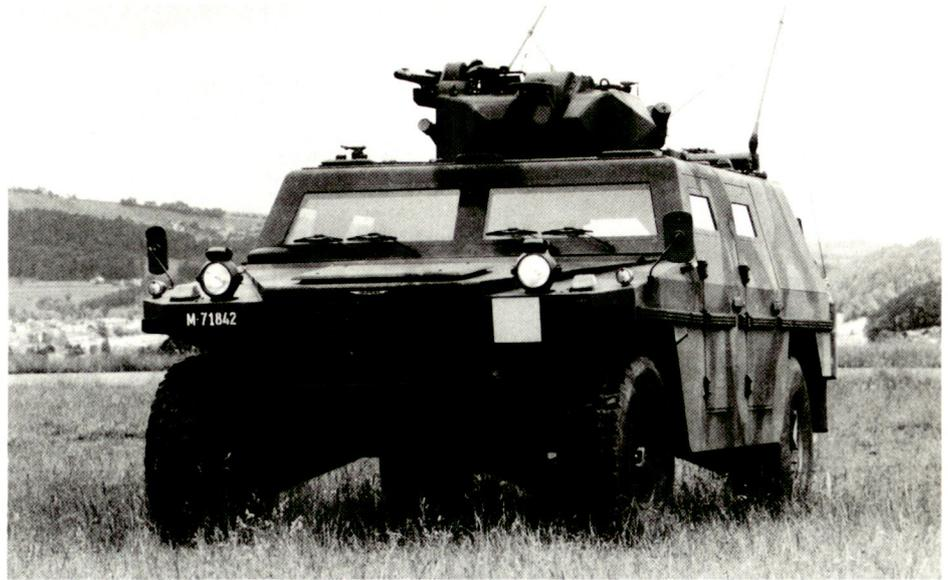
Leichtgepanzertes «Mowag»-Aufklärungsfahrzeug. Höchstgeschwindigkeit 105 km/h, Dieselmotor 6,2 Liter, 150 PS.
