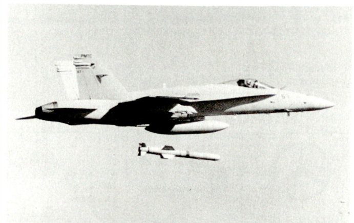
«SLAM» (Standoff Land Attack Missile) Abstandslenkwaffe mit sehr grosser Reichweite der USA. Hier kurz nach dem Abschuss ab einem U.S. NAVY F/A-18. Im Ernstfall bewährt ab A-6E und F/A-18. Die Endanflug-Kontrolle kann auch von einem anderen Flugzeug übernommen werden, dazu ist Datalink (AWW-9 oder AWW-13) notwendig.
