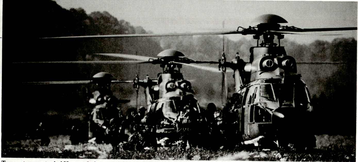
Truppentransporte sind Hauptaufgaben und dienen der Kampfunterstützung. Pro Super Puma werden 15 vollausgerüstete AdA transportiert. Praktische Nutzlast (Innen- oder Aussenlast) ungefähr 2,5 Tonnen.
