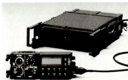
Tornisterfunkstation SEM 173 mit abgesetztem Bedienteil
