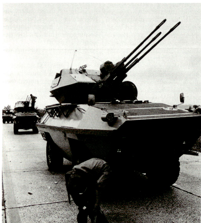
Schützenpanzer BOV-3 aus früherer jugoslawischer Produktion, der heute auch bei den bosnischen Serben im Einsatz steht.
