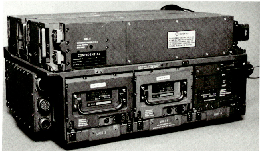
Störsystem ALQ-165 mit zwei Empfängern, Signalverarbeitungseinheit und Sender.
